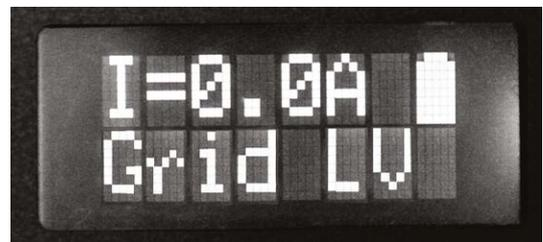
Trabajo en el modo de baja tensión - la pantalla muestra el valor de la corriente medida que fluye a través de las pinzas e indica el estado de carga de la batería
