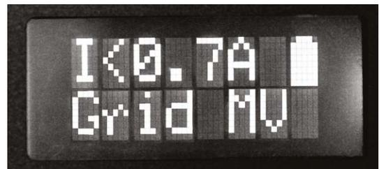
Trabajo en el modo de media tensión - la pantalla muestra el valor del umbral de alarma fijado e indica el estado de carga de la batería
