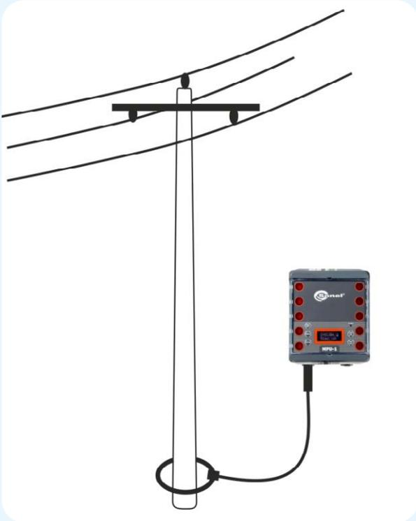
Dispositivo que funciona con una sola pinza
